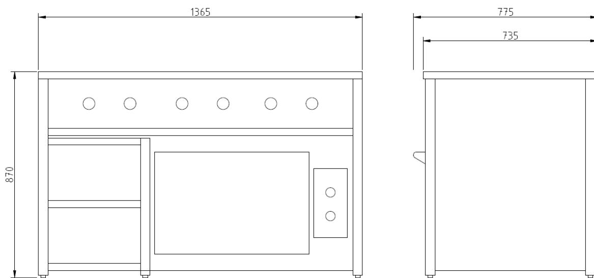
Рисунок 2. Плита электрическая 6-ти конфорочная с жарочным шкафом.
