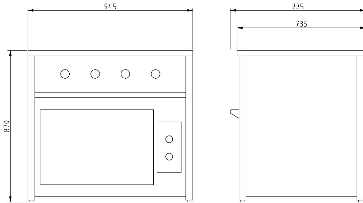
Рисунок 1. Плита электрическая 4-х конфорочная с жарочным шкафом.
