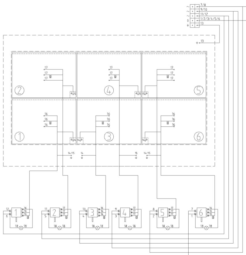
Рисунок 8. Принципиальная схема электропроводки 6-ти конфорочной электроплиты.
