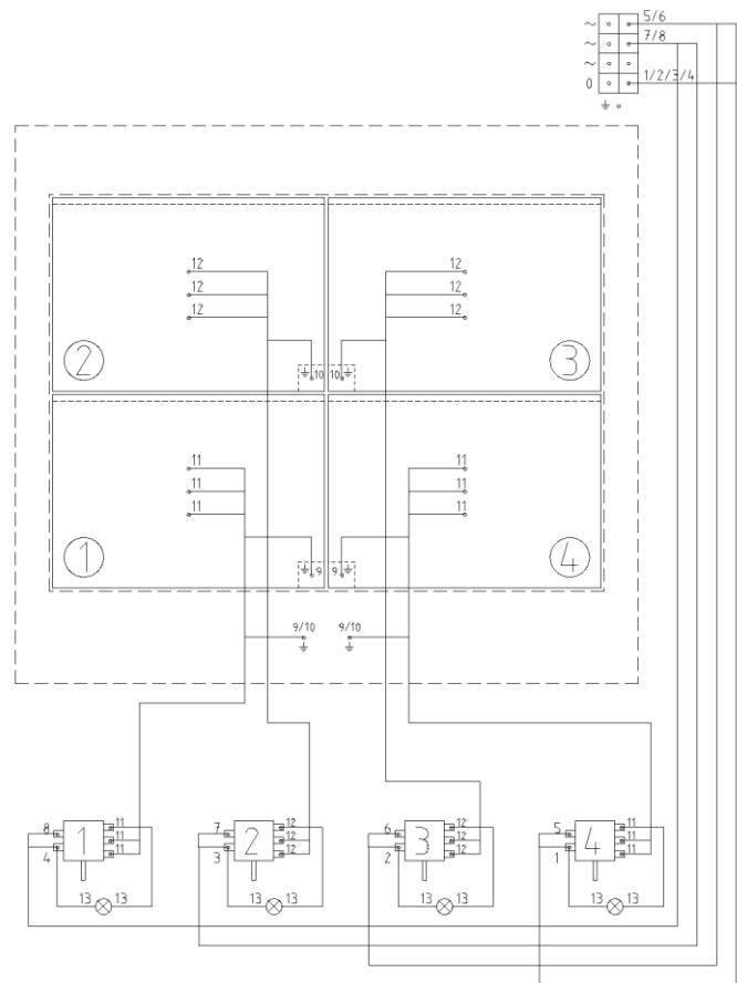
Рисунок 7. Принципиальная схема электропроводки 4-х конфорочной электроплиты.
